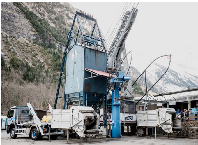
■ Links: UT-Absetzkipper mit Spezialaufbau für die Müllentsorgung über die Schilthornbahn. (Bilder: Peter Fuchs)
