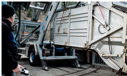
UT-Absetzkipper mit Spezialaufbau für die Müllentsorgung über die Schilthornbahn.
