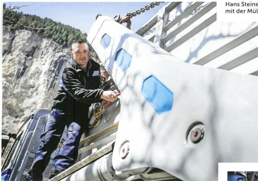
Absetzkipper mit Spezialaufbau für die Müllentsorgung über die Schilthornbahn in Mürren.
